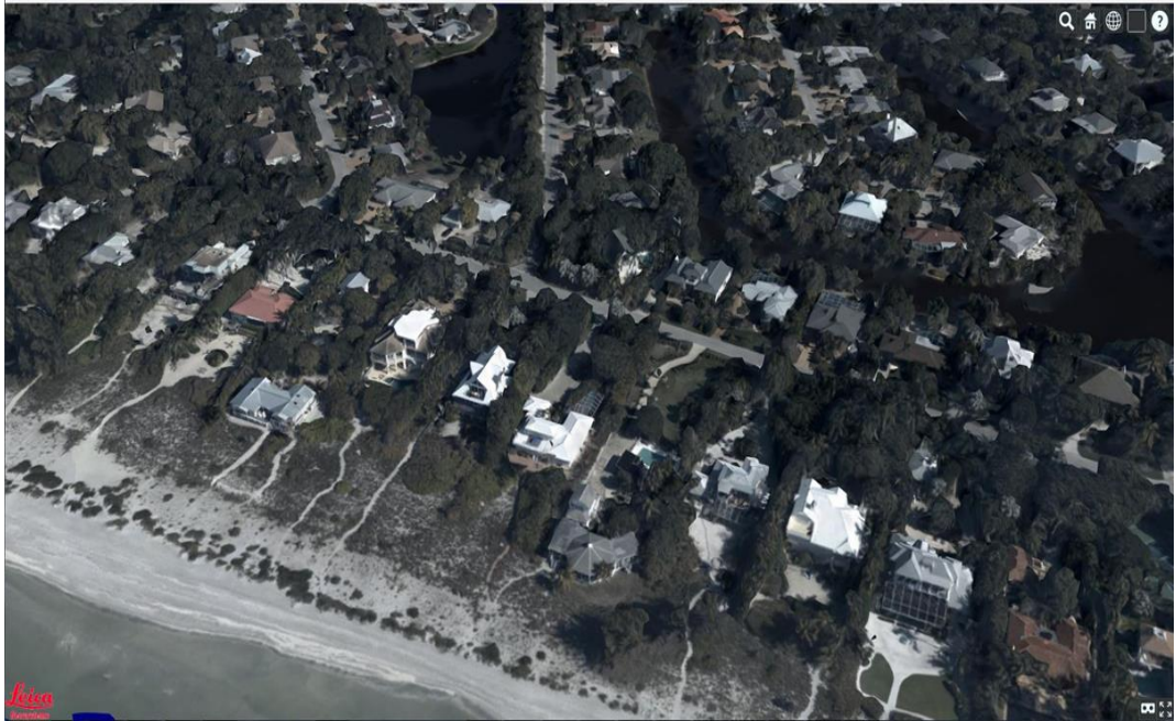
Hình 7: Lưới RGB (RGB mesh) trùm lên đám mây điểm
